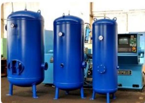
Благодаря ему удастся значительно продлить срок службы компрессора. Это обеспечивается за счет того, что благодаря ресиверу оптимизируется работа компрессора и уменьшается количество циклов пуска-остановки двигателя. К тому же, благодаря этому устройству обеспечивается равномерность подачи воздуха, и, как следствие, непрерывность технологического процесса, в котором участвует компрессорная установка.
